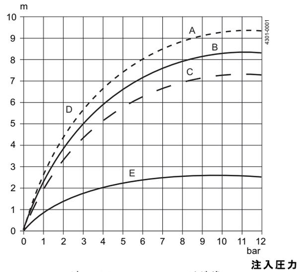
ノズル A) d = 5.5 mm B) d = 4.6 mm C) d = 3.9 mm
